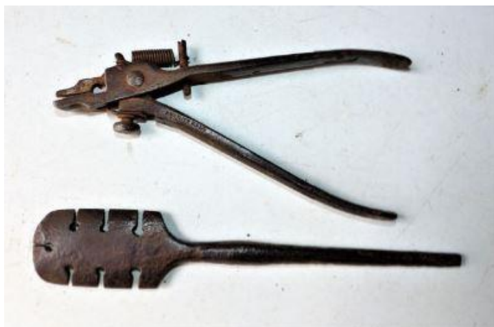
Pince et clé à avoyer les lames de scie
